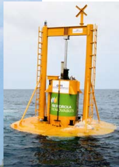
Bild 2 (oben): Bojentechnologie – Energiegewinnung über das Auf und Ab der Wellen.
