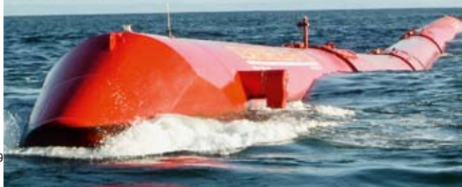
Bild 7: Die Seeschlange Pelamis erzeugt Energie über Knickbewegungen. Foto: Pelamis Wave Power
