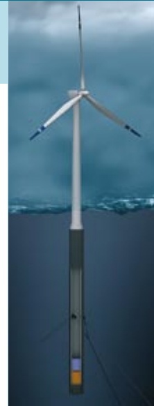
Prinzip des Spar-Buoy-Konzepts von Hywind. Foto: Statoil Hydro
