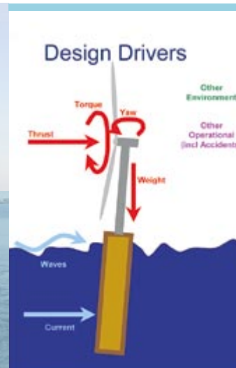
Abb. 2: Diese Kräfte treten bei Offshore-Turbinen auf. Quelle: Garrad Hassan
